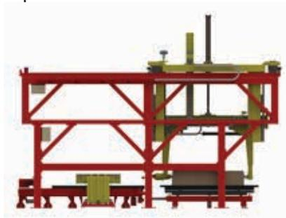
**Paso 2** - Se centra la mitad del Drag al Eje 'y', levantado y colocado en el pallet de piezas fundidas
