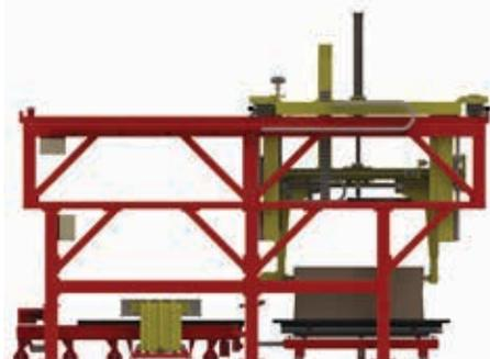
**Paso 5** - La mitad del Cope se cierra a la mitad del Drag. Se precisa asegurar alineación usando una mesa flotante
